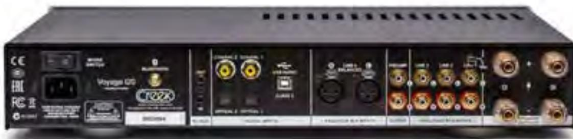
Voyagei20 インテグレイテッドアンプは、アナログプリアンプと DA コンバータにパワーアンプを
